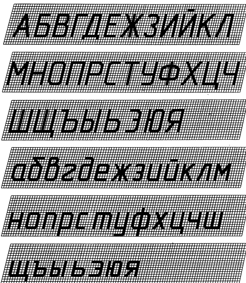
Рис. 2.15. Шрифт типа Б с наклоном
